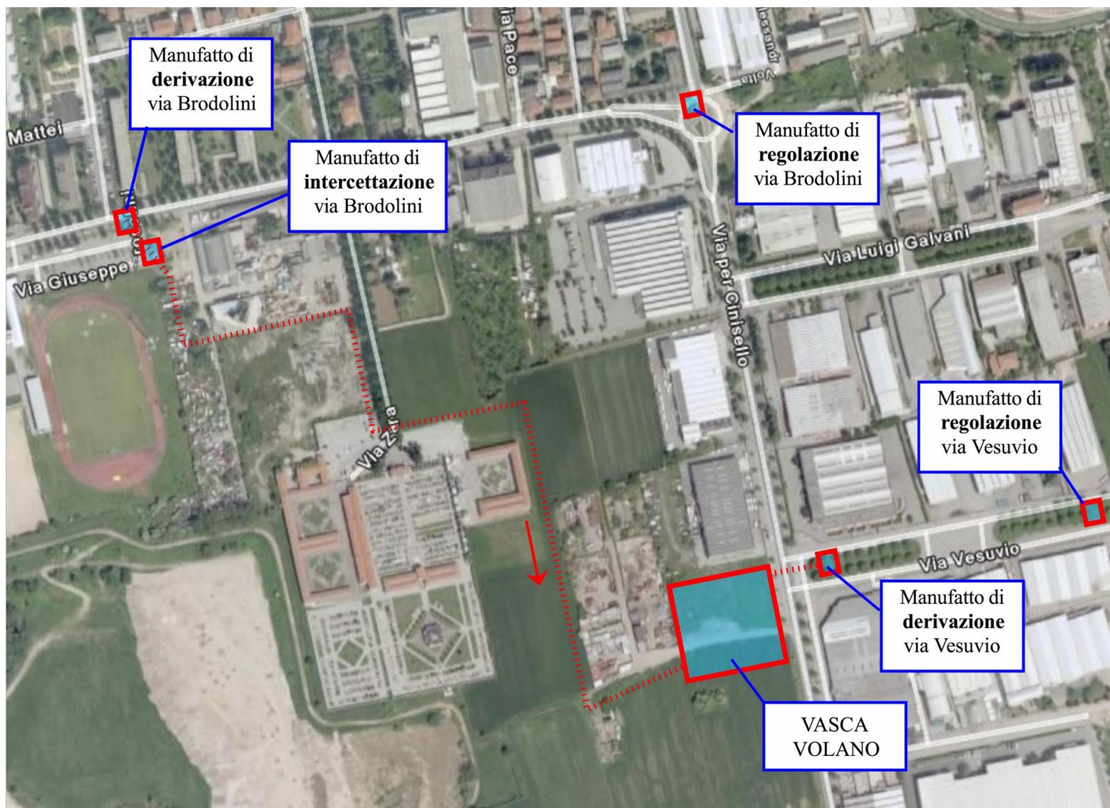
Planimetria interventi di progetto su immagine satellitare - Volume invaso utile vasca volano: 44'000 m<sup>3</sup>. Dimensioni planimetriche 70x72 m
