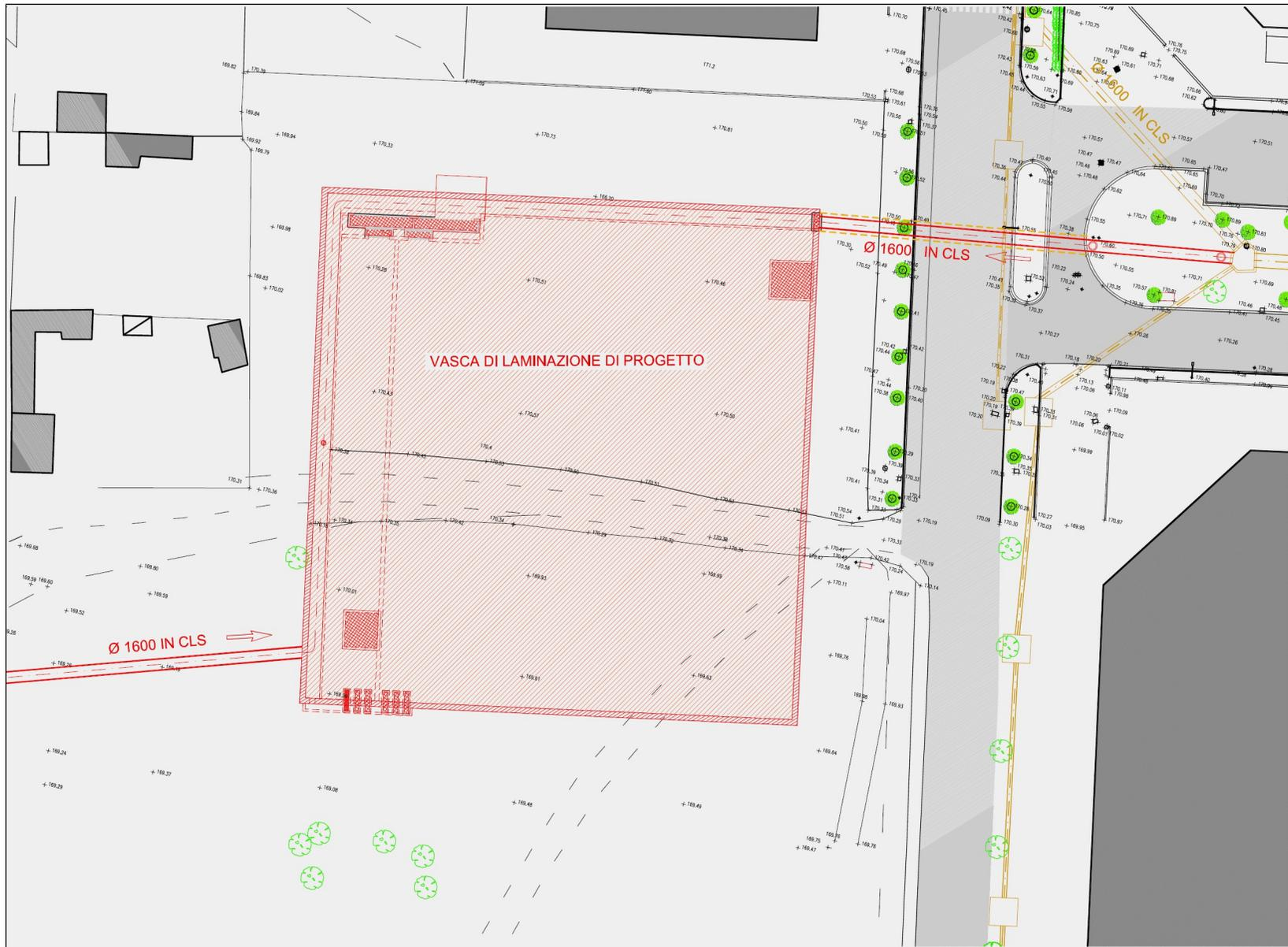
Planimetria d'inquadratura area ad ovest di via per Cinisello – Volume invaso utile: 44'000 m<sup>3</sup>. Dimensioni planimetriche 70x72 m
