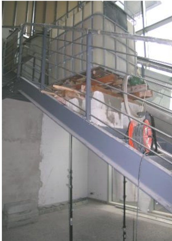
Prova di carico su scala in acciaio
