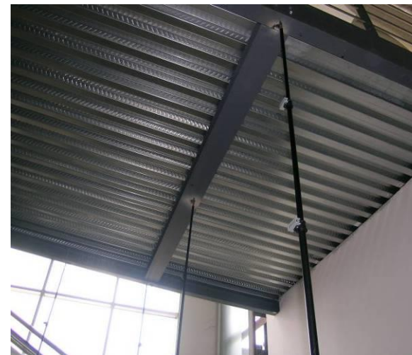
Prova di carico su passerella pedonale in acciaio
