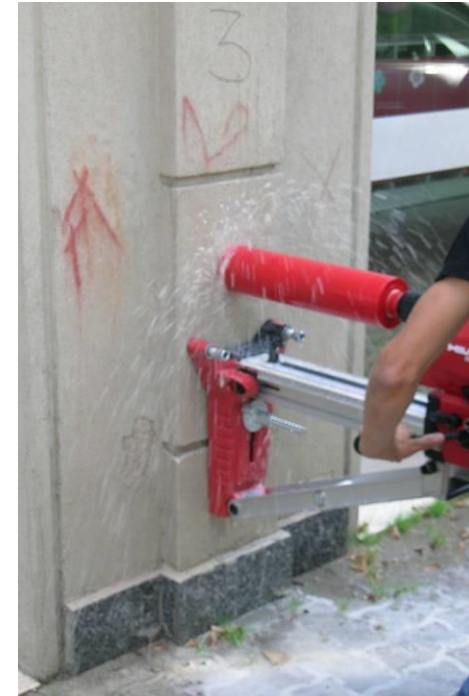
PRELIEVO CAMPIONE CON CAROTATRICE
