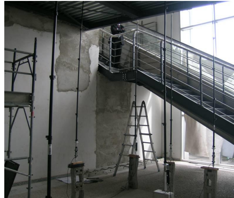
Prova di carico su passerella pedonale in acciaio
