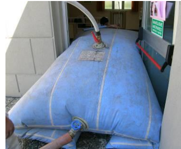
PROVA DI CARICO
